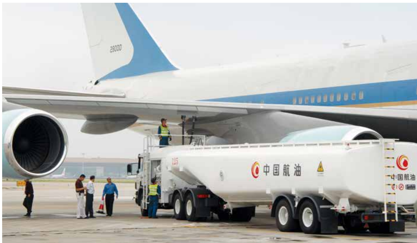
Into-plane refuelling at a PRC airport 在中国机场的航油加注服务
